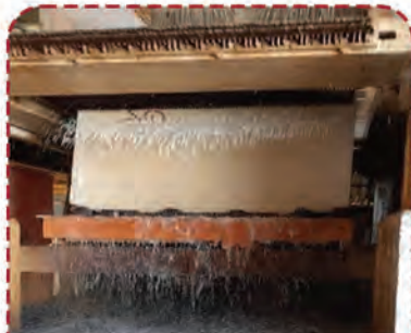
شکل ۱. برش اولیه توسط دستگاه آرهم
