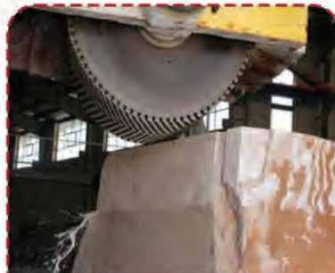
شکل ۲. تصویری دیگر از برش اولیه توسط دستگاه فلبر
